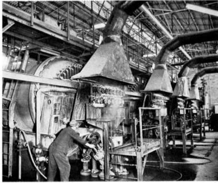
La filtration rouge : les filtres à cuve, M. Bellagamba règle l'alimentation.
